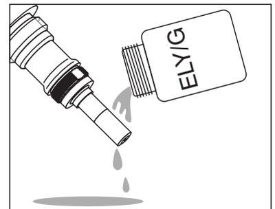
Sensorkopf mit Elektrolytlösung spülen.
